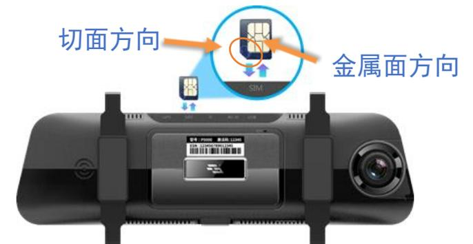
**注意：【安装时请注意金属面与切面方向，正确插入SIM卡】**
